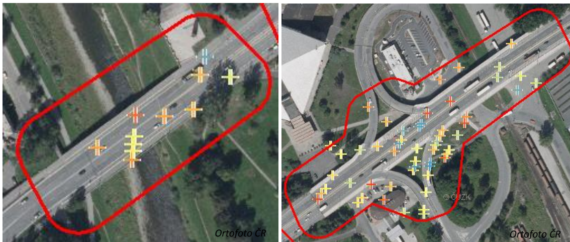
Obrázek 12 Hustota PS bodů ze zpracování SBAS ENVISAT ASAR (D dráha) s maximální relaxací ( D_A < 0.75 , Coh > 0.4 ). Je patrná nerovnoměrnost detekovaných bodů v prostoru a variabilita magnitud deformací. Z obou snímků je patrná citlivost ve směru kolmo na LOS.
