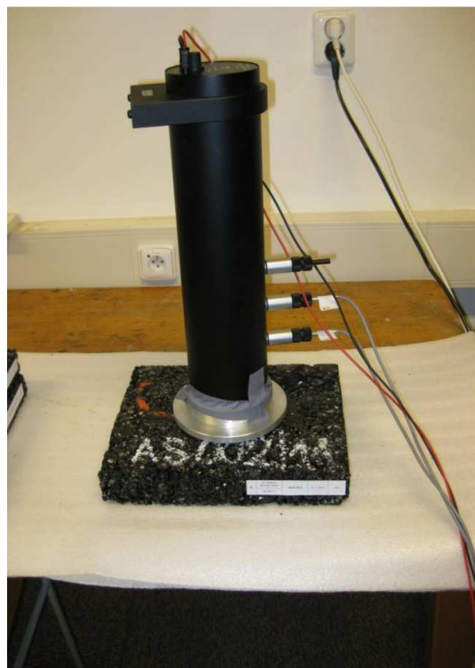
Obrázek 13: Impedanční trubice s druhou variantou náhubku pro měření pohltivosti nekruhových vzorků
