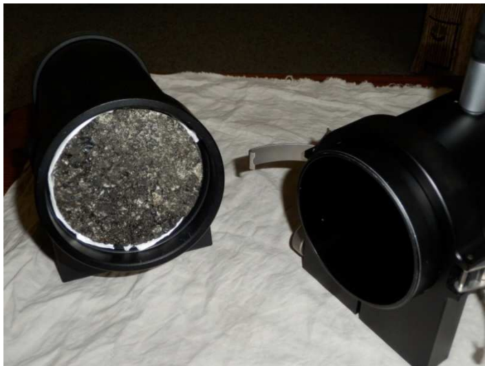
Obrázek 12: Vzorek asfaltové směsi v trubici
