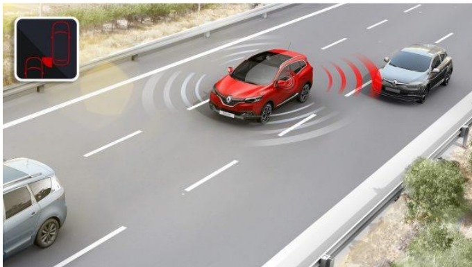
Obr. 27: Detekce vozidla ve slepém úhlu
