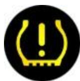
Obr. 24: Kontrolka indikující pokles tlaku v některé z pneumatik
