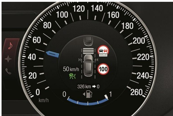
Obr. 26: Zobrazení rychlostního limitu se současným zákazem předjíždění v dané lokalitě na přístrojové desce vozidla Ford Galaxy
