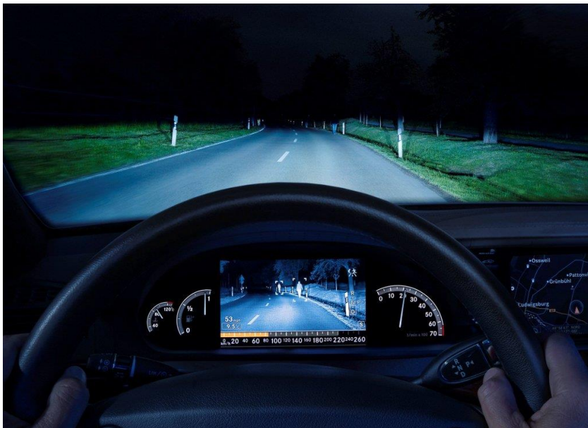
Obr. 23: Signalizace chodců na silnici na přístrojové desce při jízdě v noci
