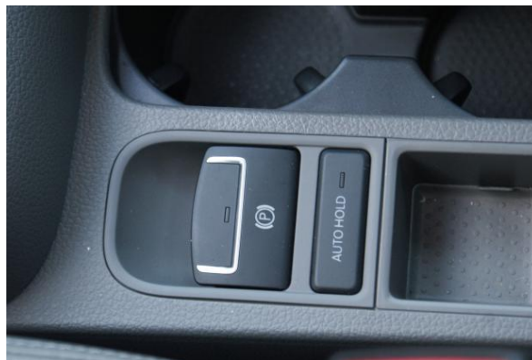
Obr. 37: Ovládání automatické parkovací brzdy u vozidla VW Sharan
