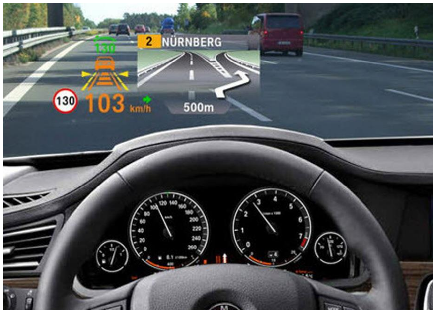
Obr. 39: Promítání provozních ukazatelů a navigace na čelní sklo prostřednictvím head-up displeje
