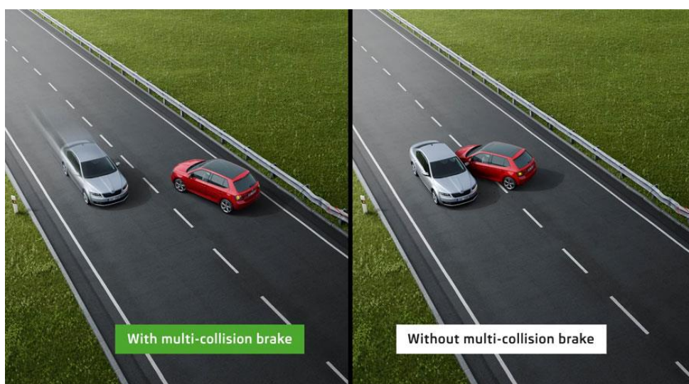
Obr. 17: Chování vozidla při postřetovém pohybu s multikolizní brzdou a bez ní
