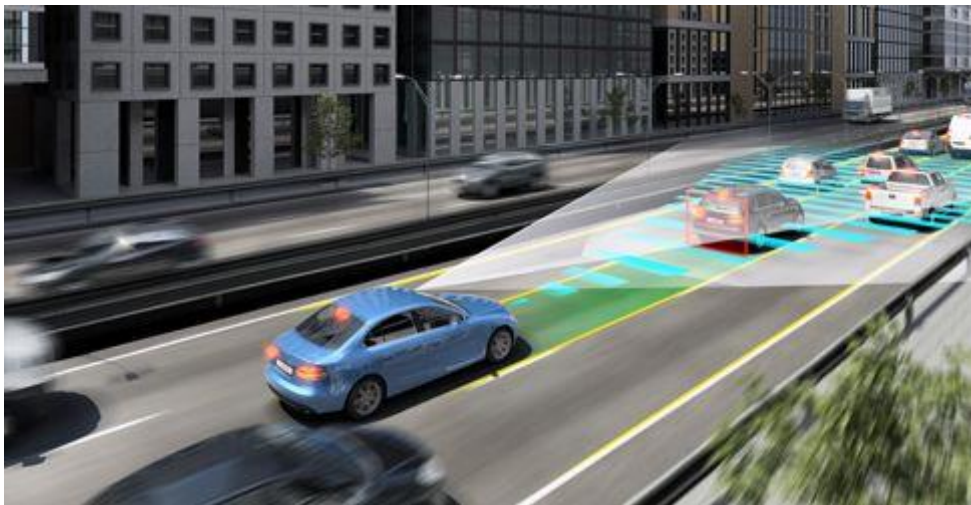
Obr. 19: Monitorování prostoru před vozidlem prostřednictvím systému PEBS
