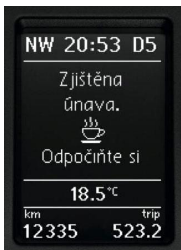
Obr. 30: Detekce únavy řidiče s upozorněním u vozidla Škoda Superb
