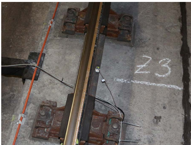
Obr. 2 Umístění snímače zrychlení na patě kolejnice.
