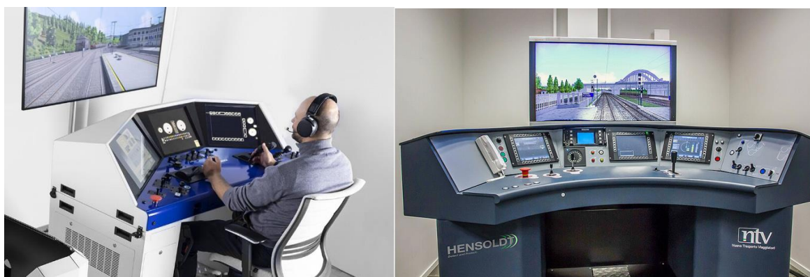
Obrázek 1: Přístrojový simulátor řízení bez kabiny, výrobce Corys (zdroj: https://www.corys.com/en/transport-simulation/simulators ) a HENSOLDT (vpravo, zdroj: https://www.hensoldt.net/services/simulation/desk-trainer-train-simulator-simsphere-train )
