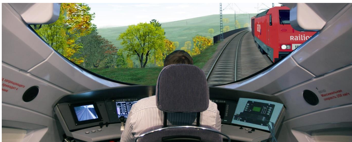
Obrázek 7: Simulátor KMW využívaný pro trénink strojvůdců DB, kde vizualizace pokrývá celé zorné pole (zdroj: https://www.kmweg.com/systeme-produkte/training-simulation/driver-training/locomotive-and-mass-transit-simulators/ )
